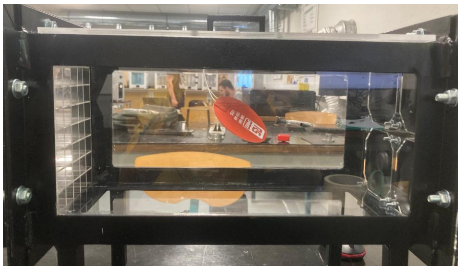
Figure 22 — Feuille modèle installée dans la veine d'essai lors du test de validation
