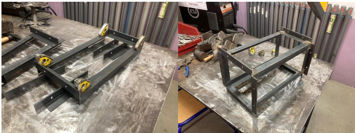
Figure 6 — Fabrication du cadre principal : (a) mise en place avec aimants de soudage avant pointage MAG, (b) cadre soudé final
