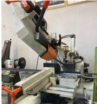
Figure 5 — Découpe des cornières 30×30mm aux longueurs calculées à l'aide de la scie à ruban KASTO
