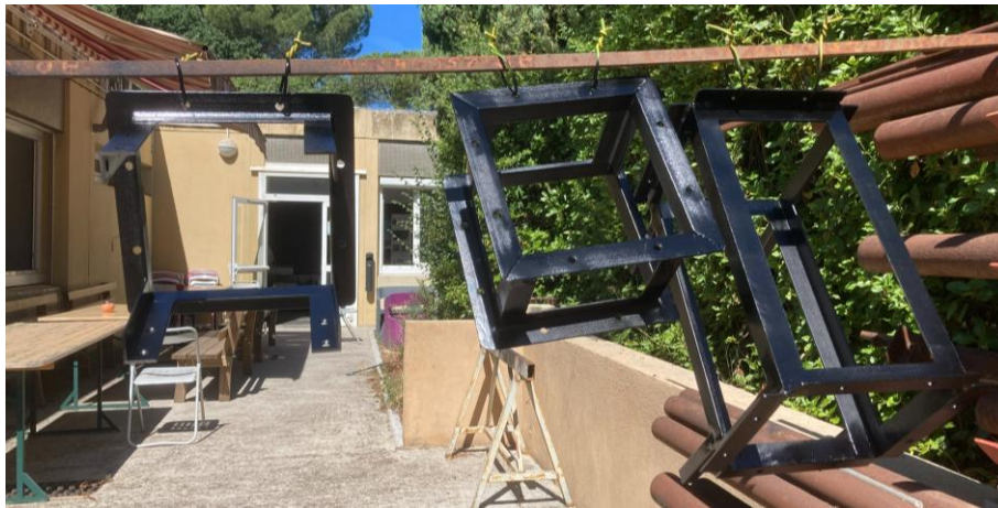
Figure 19 — Séchage des modules métalliques après application de la peinture noire à la bombe aérosol
