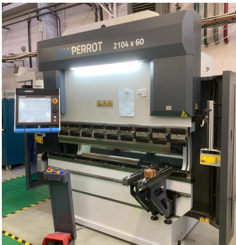
Figure 8 — Opération de pliage à 14° des barres horizontales supérieures du convergent sur la plieuse CNC Jean Perrot
